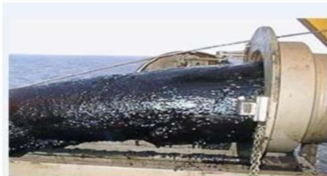
Сурет 1 – Құбыр ішіндегі шикі мұнайдың парафин тығындарының түзілуі
